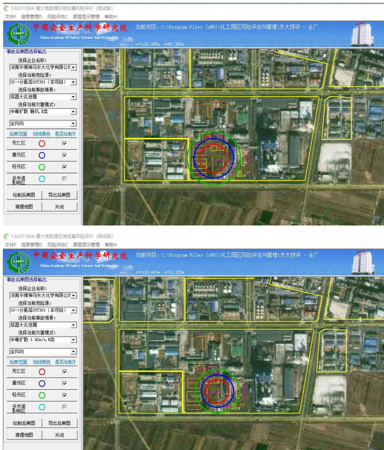
图 F3.3-3 分氨塔大孔泄漏, 静风, E 类条件下中毒扩散事故后果图
